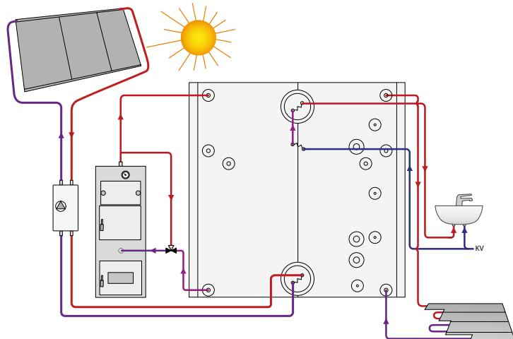
GTV TEKNIK RD отлично работает в сочетании с твердотопливным котлом, тепловым насосом или солнечным коллектором. Внутренняя пластина обеспечивает равномерное распределение тепла.
