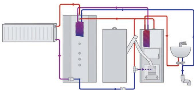
Jäspi Pelletti XL с теплоаккумулятором при эксплуатации на дровах
