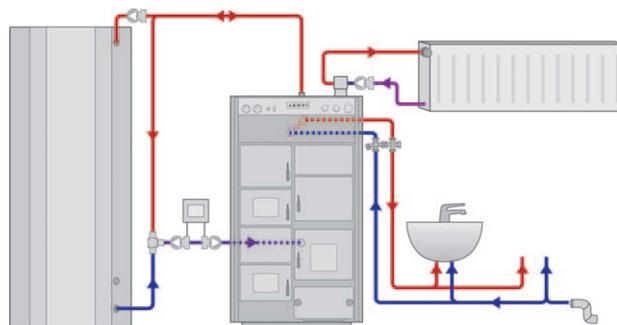
Jäspi Biotriplex с теплоаккумулятором и подключением к солнечным панелям
