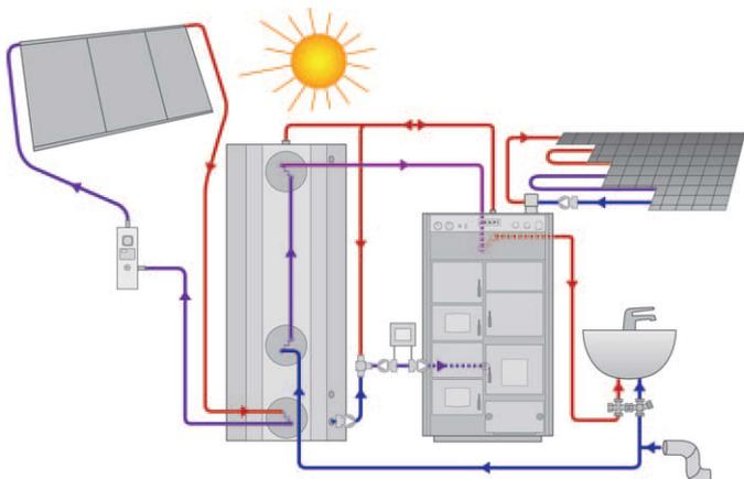
Jäspi Pelletti 25 с теплоаккумулятором
