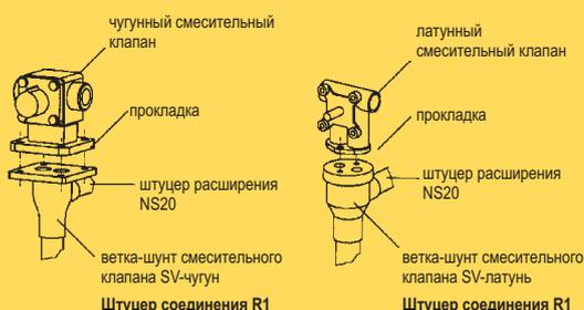
В дизельно-/газовых и комбинированных котлах Jäspi стандартно один 4-ходовой смесительный клапан с установкой на котле.
